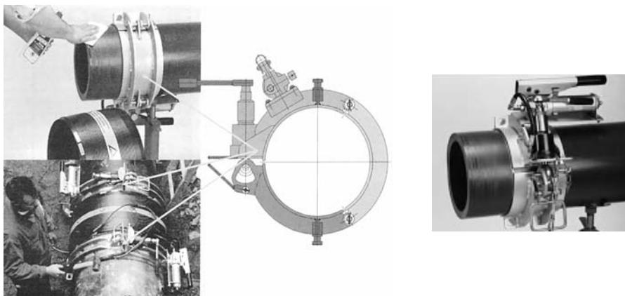
Фото 4.2.7. Гидравлические выравнивающие машины позволяют устраниить овальность труб для качественной сварки в муфте с ЗН
