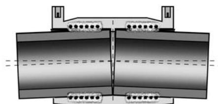
Рис. 4.2.17. Установка труб с перекосом является одной из причин некачественной сварки.
