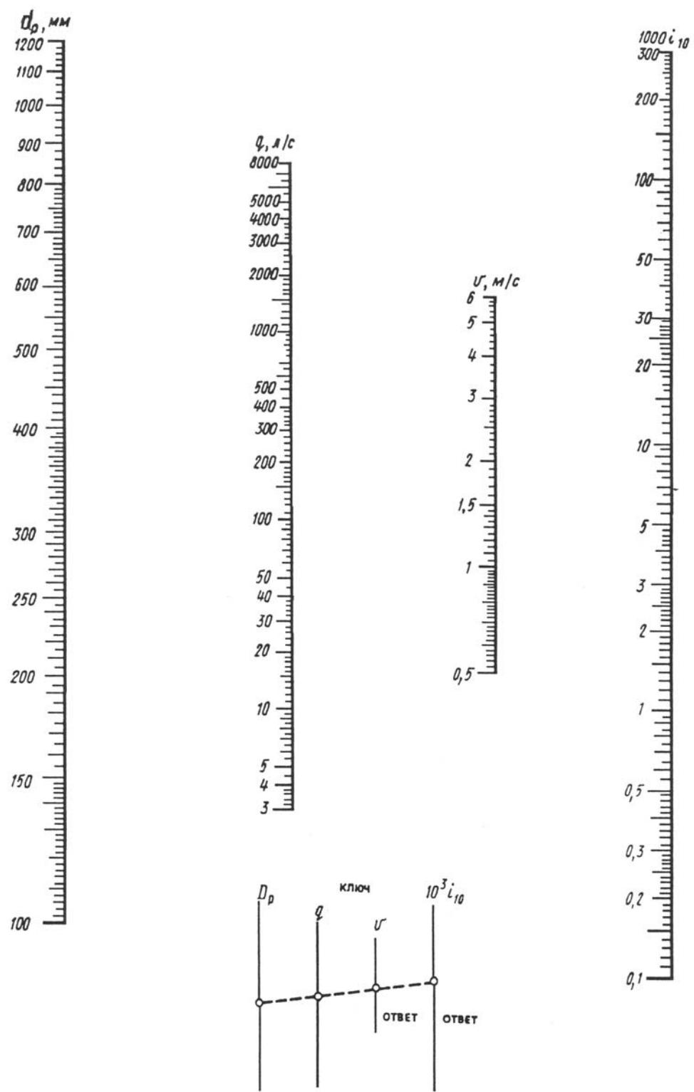
Рис. 2.2 Номограмма для определения потерь напора в трубах диаметрами 100 -1200 мм.
