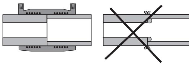
Рис. 4.2.3. Использование муфты с ЗН позволяет сваривать трубы с различным SDR
