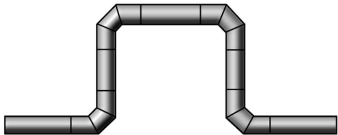
Рис. 2.5. «П»-образный компенсатор
