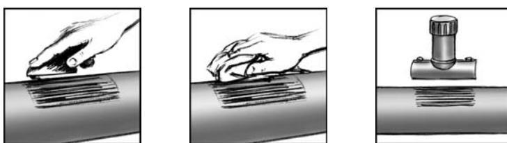
*Рис. 4.2.15. Снятие оксидного слоя для установки седлового отвода*
