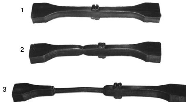
Фото 4.2.9. Образец с фрагментом стыкового сварного соединения (1).
