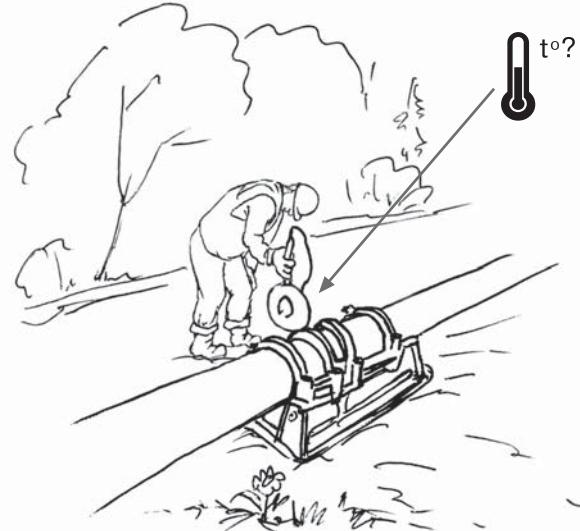
Рис. 4.2.9. Контроль температуры на поверхности нагревателя
