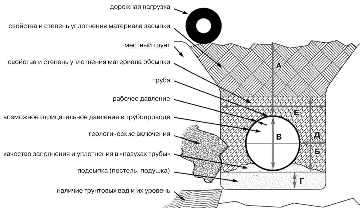
**А** – расстояние до поверхности, **Б** – расстояние до стенки траншеи, **В** – диаметр трубы,
