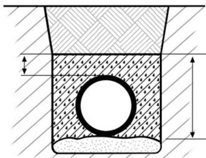
Рис. 4.1.4. Обсыпка трубопровода
