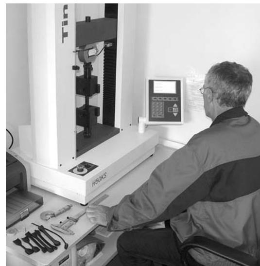
Фото 4.2.8. Испытания стыковых сварных соединений в лаборатории ИКАПЛАСТ
