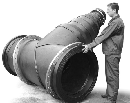
Фото 4.2.3 Примеры соединительных деталей и узлов ИКАПЛАСТ, выполненных сваркой встык. Слева: неравнопроходной тройник 900 x 200 SDR 17 ПЭ 100. Справа: тройник ИКАПЛАСТ монолитный 1000x225 SDR 17 ПЭ 100
