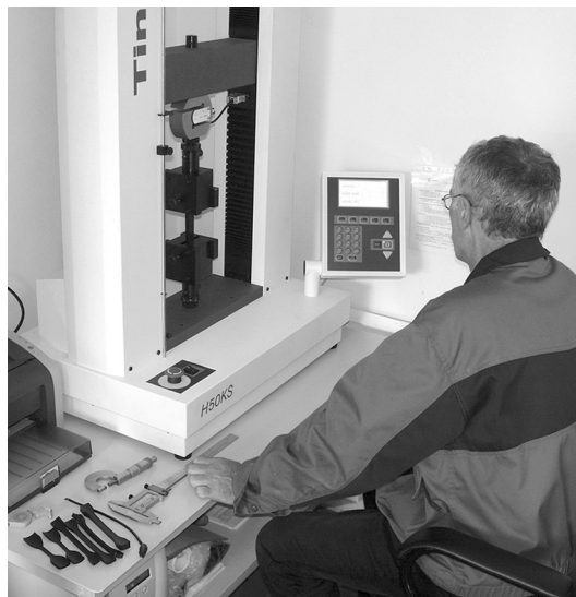
Фото 4.2.8. Испытания стыковых сварных соединений в лаборатории ИКАПЛАСТ
