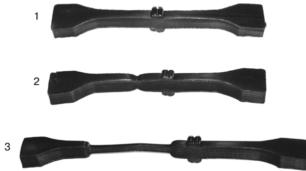
Фото 4.2.9. Образец с фрагментом стыкового сварного соединения (1).
